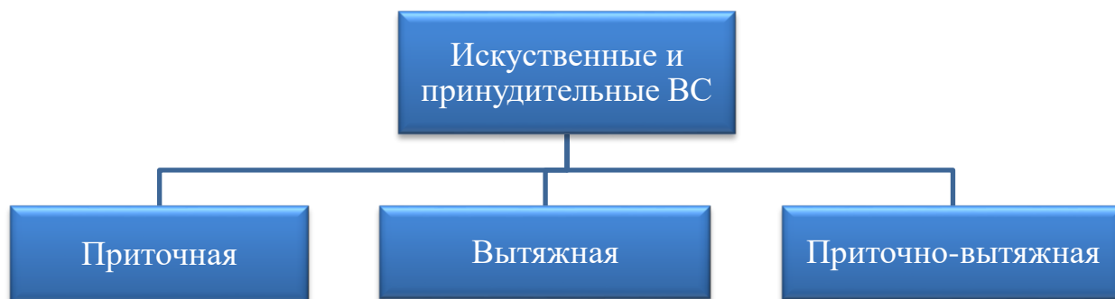
Рисунок 1.1 – Подвиды вентиляционных систем
